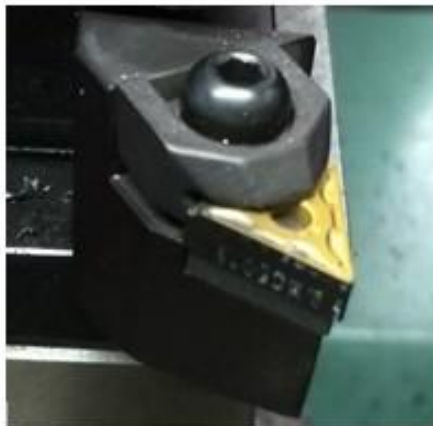
Figura 4 - Ferramenta de corte instalada
