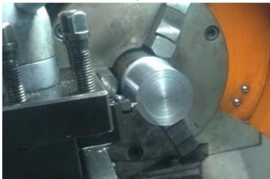
Figura 5 - Bloco fixado na placa universal do torno
