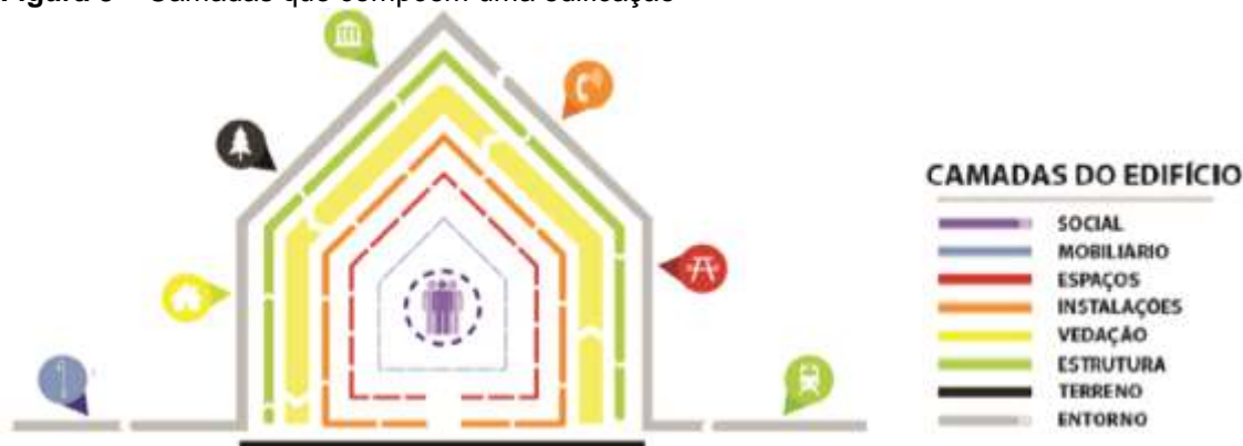
Figura 3 – Camadas que compõem uma edificação
