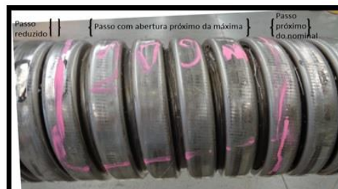
Figura 6 – Variação de passo na carcaça de duto flexível.
