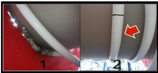
Figura 3 – Branqueamento no enrolamento do duto.
